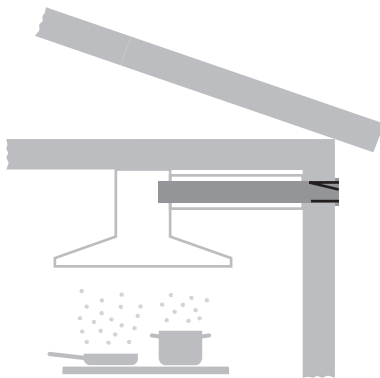
Con canale di scarico laterale visibile
