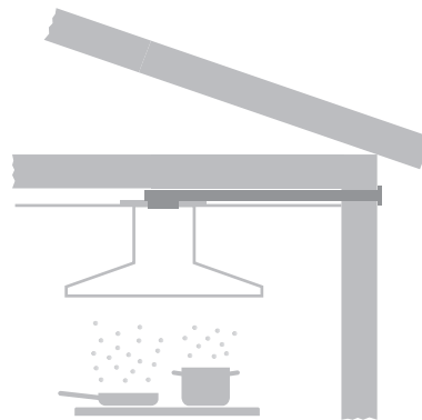
Con canale di scarico nascosto, ad es. in un controsoffitto con conduttura dell'aria di scarico in canale piatto
