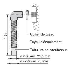
Hauteur de refoulement max. à partir du sol pour modèle de série: 1200 mm
