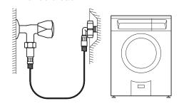
Tuyau blindé métallique avec filtre fin, longueur: 1,25 m, G3/4".
