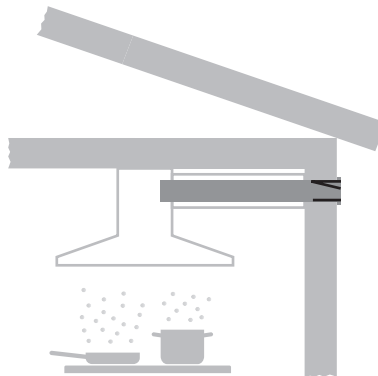
Mit seitlich sichtbarem Abluftkanal
