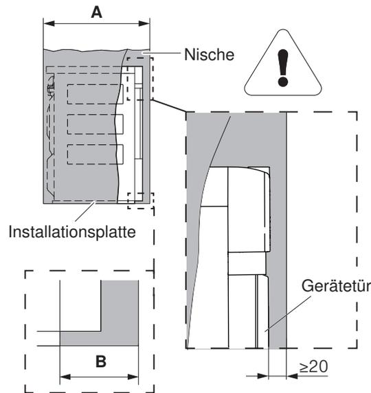
Die von der Geräterückseite abgegebene Wärme muss aus der Nische abgeleitet werden. Mittels 2 Lüftungsgittern P33002 oder mit einem Lüftungsquerschnitt von min. 400 cm<sup>2</sup> ist im Nischendeckel für Frischluftzufuhr über die Anschlussöffnung zu sorgen.
