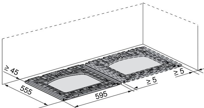
Mass 45 und 555 nur gültig, wenn hinter dem Gerät keine Anschlussarmaturen angebracht werden.
