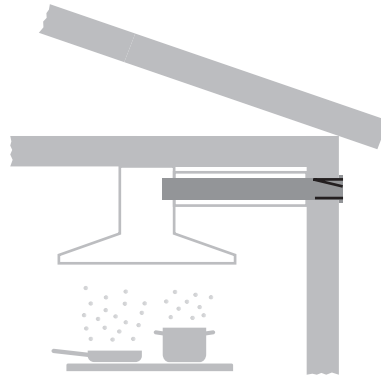
Mit seitlich sichtbarem Abluftkanal
