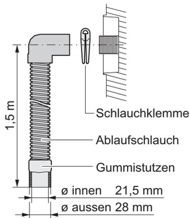
Max. Förderhöhe ab Geräteboden in Serieausführung: 1200 mm
