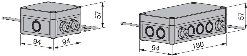
Das Optionen-Steuerset dient zur Steuerung fremder Geräte (z. B. Ventilator) durch ein Steuersignal, das von einem V-ZUG-Gerät erzeugt wird. Für ein einwandfreies Zusammenspiel müssen die elektrischen Eigenschaften der beiden Bestandteile bekannt sein. Eine sorgfältige Abklärung ist notwendig und setzt elektrotechnische Fachkenntnisse voraus. Die Planung und Installation sind deshalb elektrotechnischem Fachpersonal vorbehalten.
