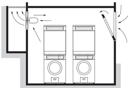
Wärmeableitung ins Freie, keine Nutzung der Abwärme.
