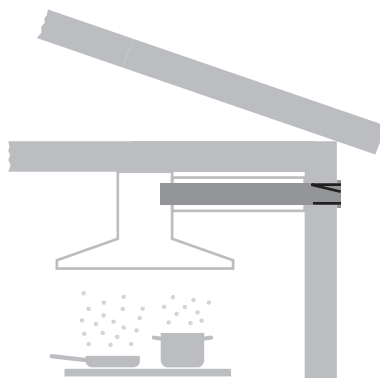
Avec gaine d'évacuation d'air latérale apparente
