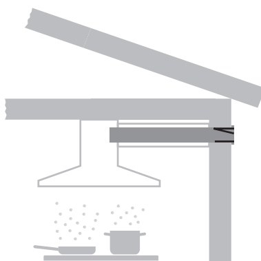
Avec gaine d'évacuation d'air latérale apparente
