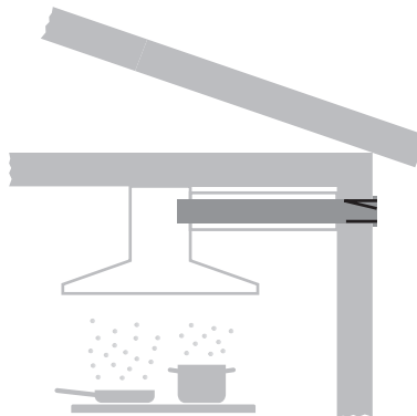
Mit seitlich sichtbarem Abluftkanal
